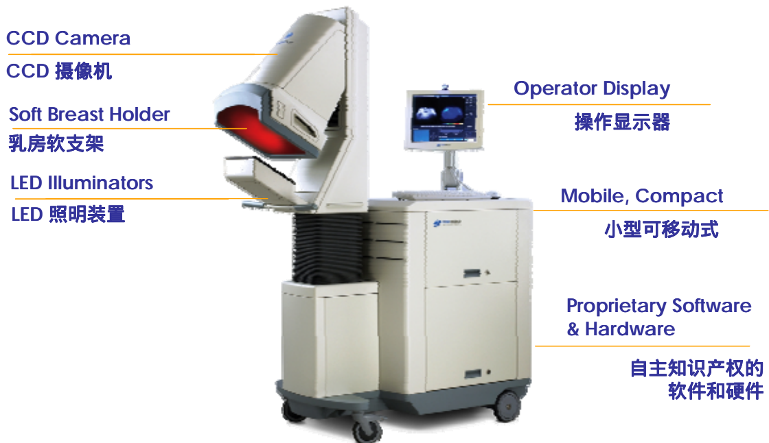
图 2. DOBI 舒怡（ComfortScan）系统结构图及主要组成部件
